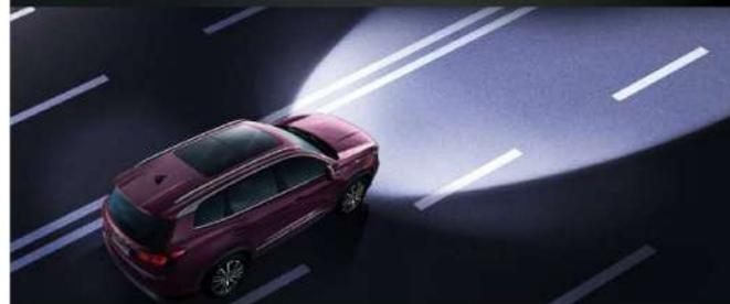
El Control de Luz Alta Inteligente permite analizar las luces de los vehículos que vienen en sentido contrario, regulando automáticamente la intensidad de las luces entre altas y bajas.
