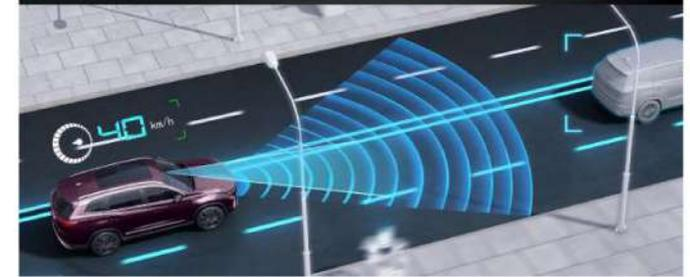
El Asistente de Atasco de Tráfico monitorea los movimientos de los vehículos en carriles cercanos, avisando al conductor y mostrando en pantalla una alerta cuando éste note que el carril por donde va con menor movimiento. Permitiendo así una sugerencia de cambio de carril para avanzar más rápido.
