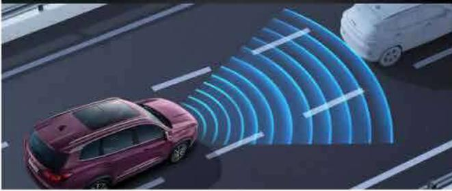
El Control Crucero Adaptativo permite monitorear las condiciones del tráfico, copiando la velocidad del vehículo que se encuentra adelante. El TIGGO 8 PRO regula los cambios de velocidad de manera autónoma y así manteniendo una distancia segura para reaccionar en casos de emergencia.
