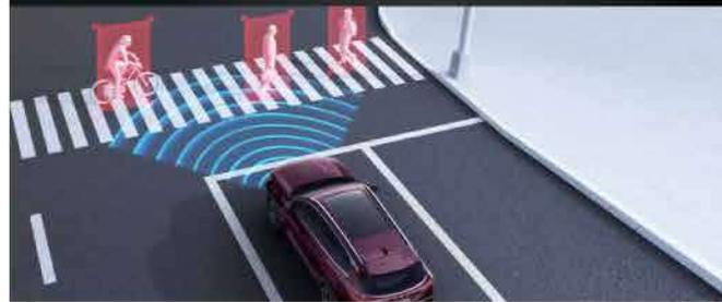
Permite mediante sensores ubicados en la parte frontal, monitorear las condiciones de tráfico, en caso de detectar obstáculos inesperados en frente, emite una alerta sonora y visual en el tablero, previniendo posible colisión.
