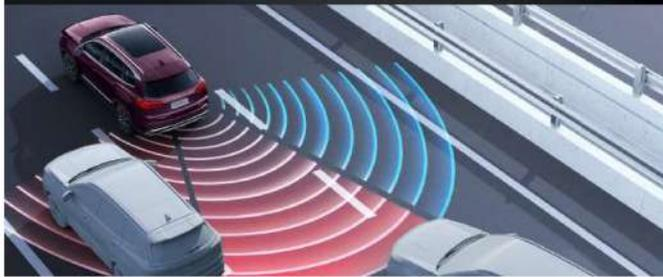
El poder rebasar o cambiarse de carril puede ser una maniobra peligrosa en carretera, en especial si no se tiene un panorama claro del otro carril (el punto ciego). En el TIGGO 8 PRO el BSD permite que, mediante radares microondas, se alerte al conductor si es factible el cambio de carril o no.
