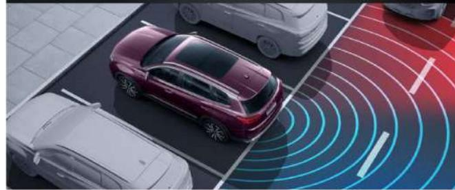
El Asistente de Tráfico Cruzado Posterior monitorea condiciones de tráfico en un rango de 30m, detectando si existen obstáculos o vehículos que no son visibles por los espejos retrovisores. Avisa al conductor mediante una señal luminosa si hay presencia de estos.
