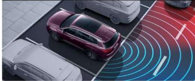
El Asistente de Tráfico Cruzado Posterior monitorea condiciones de tráfico en un rango de 30m, detectando si existen obstáculos o vehículos que no son visibles por los espejos retrovisores. Avisa al conductor mediante una señal luminosa si hay presencia de estos.
