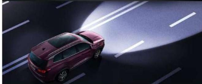
El Control de Luz Alta Inteligente permite analizar las luces de los vehículos que vienen en sentido contrario, regulando automáticamente la intensidad de las luces entre altas y bajas.
