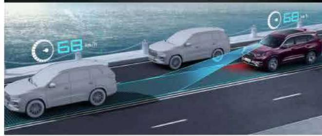
La Asistencia de Crucero Integrado permite monitorear las condiciones de tráfico, copiando la trayectoria del vehículo que se encuentra adelante. De esta manera controla la dirección del volante de forma automática con la trayectoria correcta para reaccionar en caso de emergencia.
