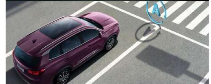
El vehículo al permanecer estático (ej.: semáforo en rojo) apagará el motor hasta que este se vuelva a encender mediante el conductor presionando el acelerador.
